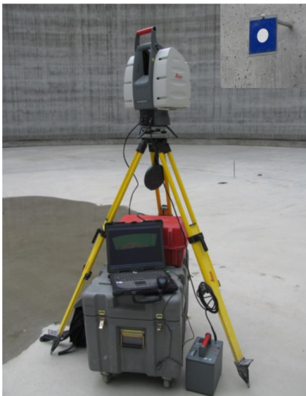
Obr. 12: Laserový skener Leica Cyrax HDS3000 s programovým vyhodnocovacím systémem Cyclone ver. 5 a detailem vřícovacího bodu – obrázek nádrže pro strategické zásoby pohonných hmot Česka (Loukov)
