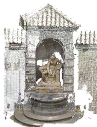
Výsek mračna pořízeného digitální fotogrammetrií
